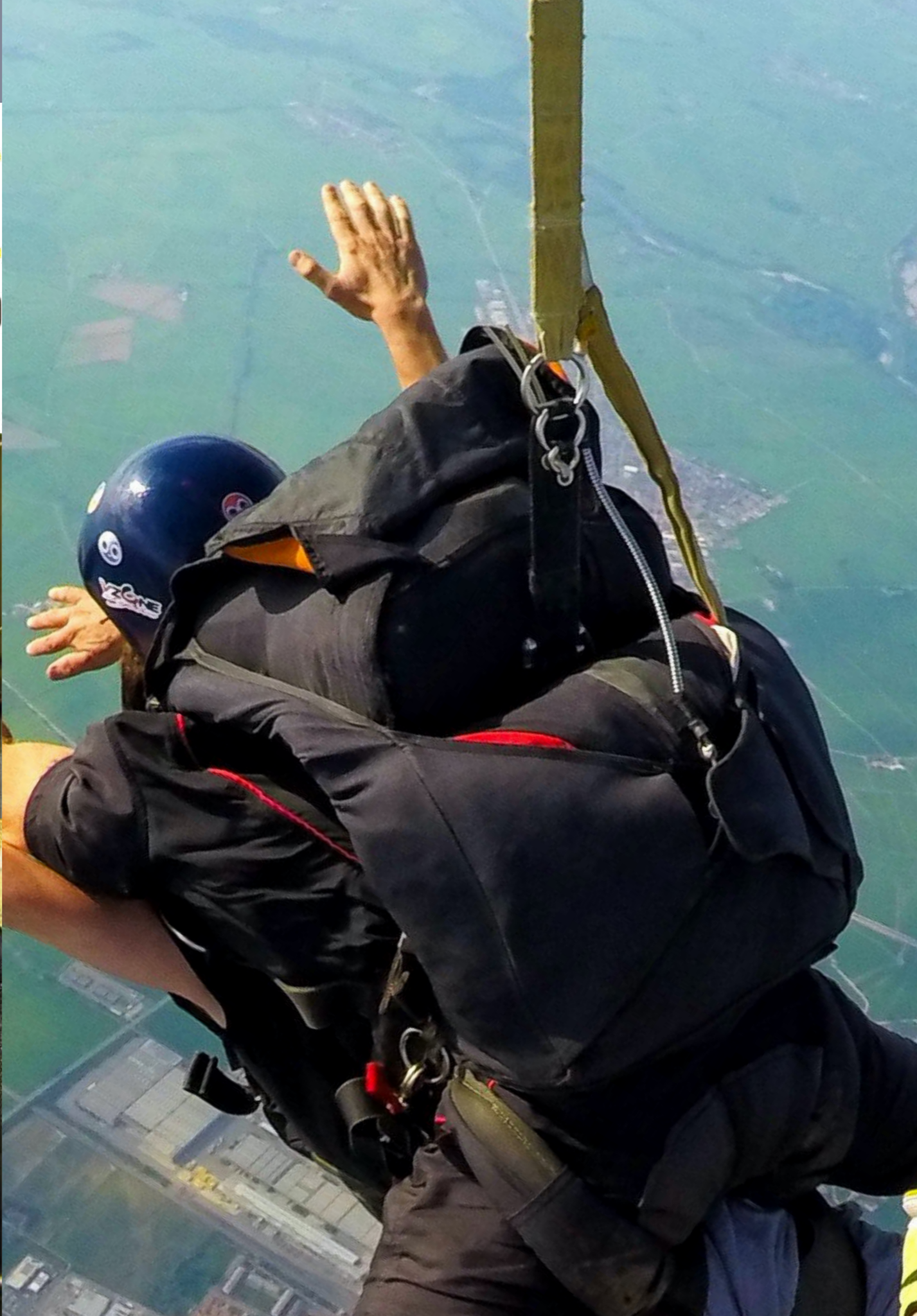
Dettagli di vincolo del drogue con sistema a 3 Anelli montato da Strong su Dual Hawk
